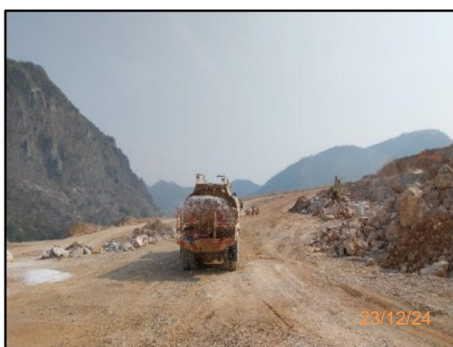
รูปที่ 2-14 การฉีดพรมน้ำบริเวณเส้นทางขนส่งแร่
