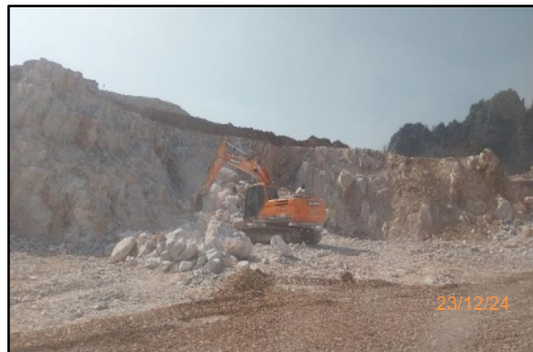
รูปที่ 2-22 การทำความสะอาดหน้างานก่อนจุดระเบิด
