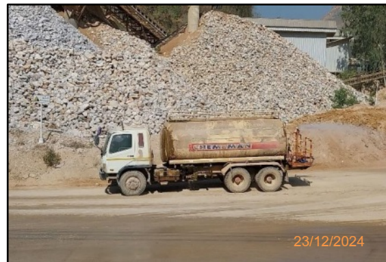
รูปที่ 2-12 การจัดเตรียมขนย้ายเศษดิน และเศษหิน ออกจากพื้นที่หน้าเหมือง และการจัดเตรียมรถฉีดพรมน้ำบริเวณที่มีกิจกรรมการขนย้าย
