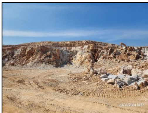
รูปที่ 2-11 การเปิดหน้าเหมืองลักษณะชั้นบันได
