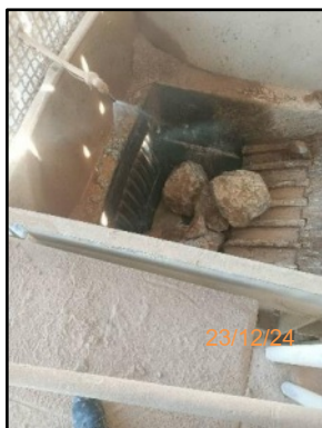
รูปที่ 2-18 ระบบสเปรย์น้ำที่จุดกำเนิดฝุ่น
